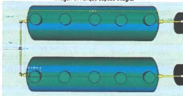
Imagen 8. Tanque séptico integral
