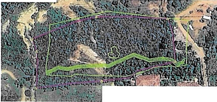
**Figura 5.** Información levantada en campo con el equipo de precisión GNSS CHC i90 PRO y recorrido realizado en la RNSC "BIOPARQUE MÓNCORA" en el marco del seguimiento (Color morado) vs el polígono de la RNSC "BIOPARQUE MÓNCORA" inscrita en el Registro Único Nacional de áreas protegidas – RUNAP (Color Verde)
