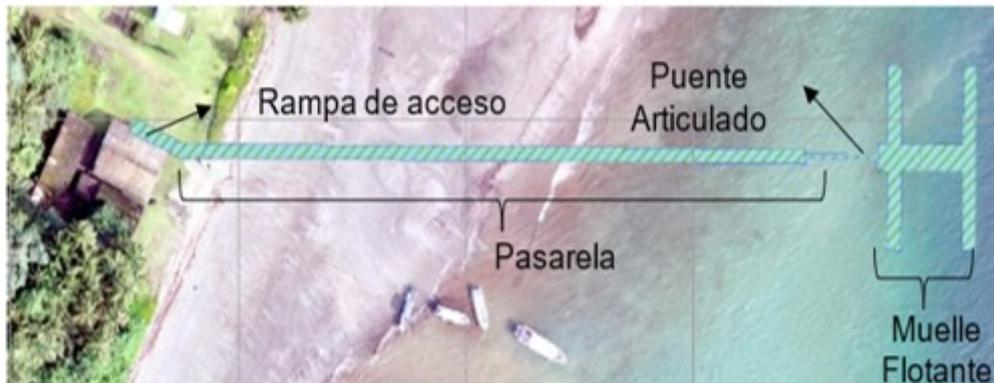
**Figura 1-1 Componentes del muelle – planta**
